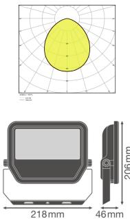
**Technische Daten Ledvance LED-Scheinwerfer GEN 3 Schwarz 50W 5500lm 100D - 830 | IP65 - Symmetrisch - Ersatz für 100W**
