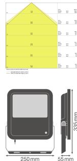
**Technische Daten Ledvance LED-Scheinwerfer Photocell GEN 3 Schwarz 80W 10000lm 100D - 840 | IP65 - Lichtsensor - Symmetrisch**
