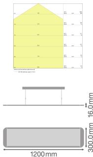
**Caractéristiques Ledvance Dalle LED Direct/Indirect 30x120cm 4000K 36W UGR <19 | Remplacement 2x36W**
