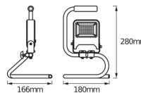
**Caractéristiques Ledvance Projecteur LED Projecteur de chantier S-Stand 20W 1700lm 120D - 840 | IP65 - Symétrique**
