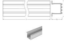
Caractéristiques Ledvance Rubans LED Profil Wide forme en U Wing 39x26mm 100CM
