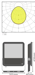
Caractéristiques Ledvance Projecteur LED Photocell GEN 3 Noir 165W 20000lm 100D - 840 | IP65 - DéTECTEUR de lumière - Symétrique
